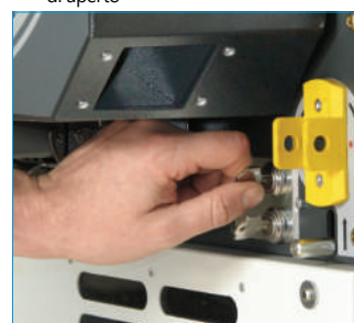
8 Sblocco a chiave del ST in aperto (se previsto)
