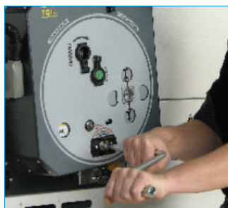
4 Sblocco del sezionatore
